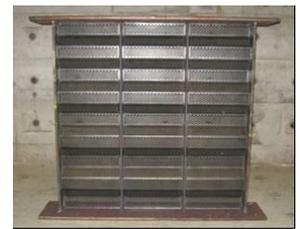
孔開き波形鋼板耐震壁
