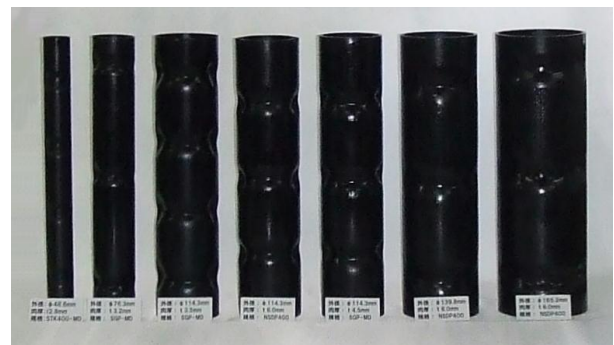
写真-2 段付鋼管
