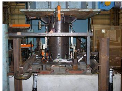
写真-1 交番載荷試験状況
