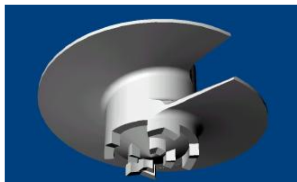
図-2 拡底型および多翼型杭の先端形状
