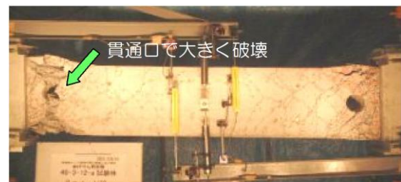
従来工法で補強された試験体
