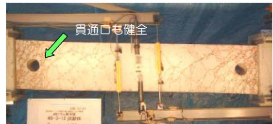
Z-M ダイヤレン工法で補強された試験体
