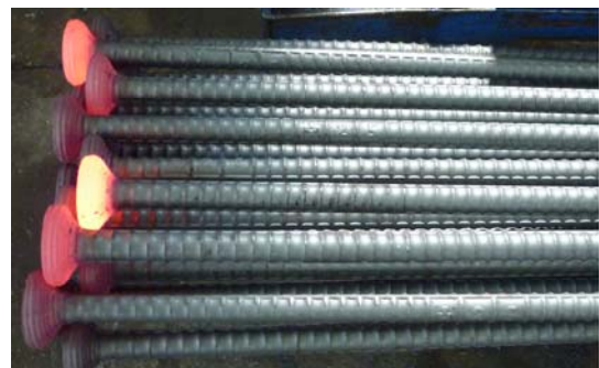
写真-1 Tヘッド工法鉄筋
