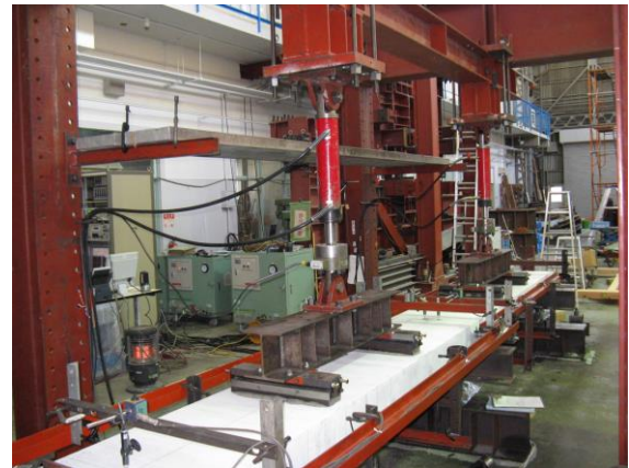
CDメッシュを合成スラブに用いた構造物実験
