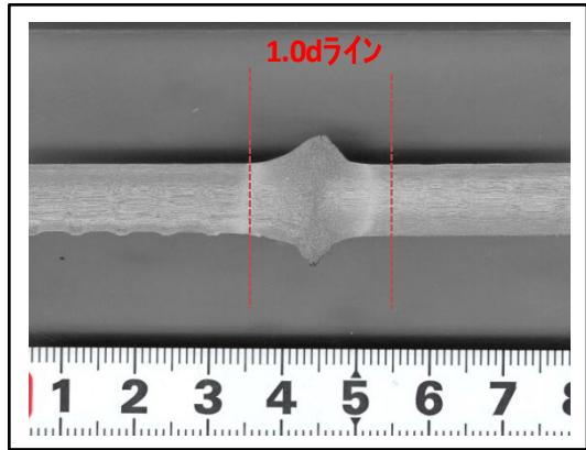
写真 9-\* マクロ試験結果 (BUE-60Y 型、SD295A-D10)
