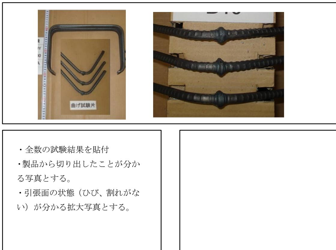
写真 11-\* 曲げ試験結果 (BUE-60Y 型、SD295A-D10)
