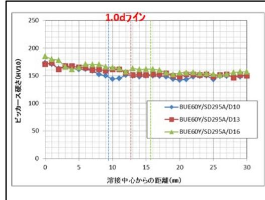
図 9-\* 硬さ試験結果 (BUE-60Y 型、SD295A-D10)
