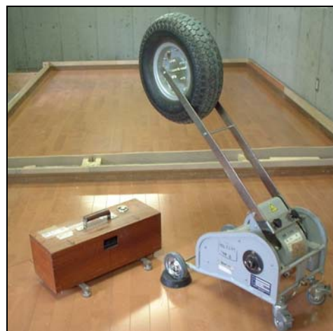
写真：試験に用いる標準衝撃源 (左：軽量衝撃源、右：重量衝撃源)
