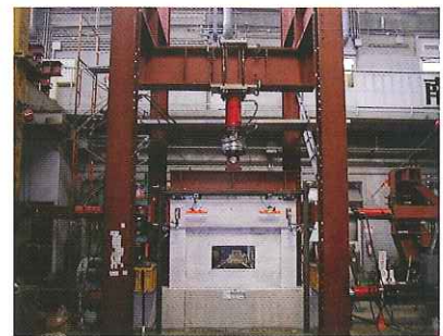
RC増設耐震壁の実験
