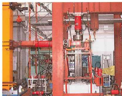
鉄骨露出型柱脚の実験
