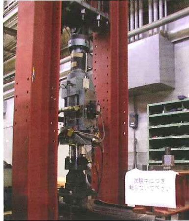
照明燈柱脚部の曲げ疲労実験
