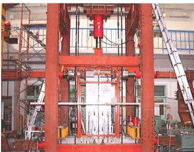
RC造PCa壁柱の実験
