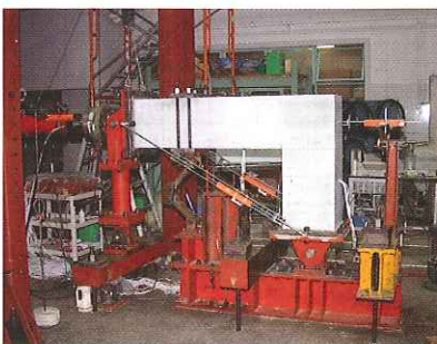
RC造L形部分架構の実験
