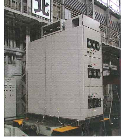
配電盤の耐震実験
