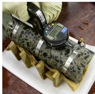
写真1 コアの長さ変化測定状況
