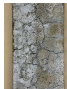
写真3 「無害でない」と判定されたモルタルバーの表面状態の例
