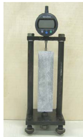
写真1 モルタルバーの長さ変化測定状況
