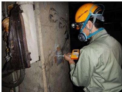
リバウンドハンマーを用いて JIS A 1155 に基づきコンクリート表面の反発度を測定し、火災の影響を受けている箇所と受けていない箇所の測定結果を比較します。
