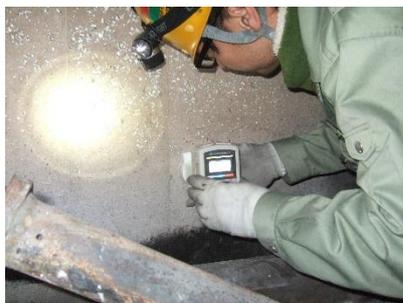
分光測色計を用いてコンクリート表面の色を測定し、変色の状況からコンクリート表面の受熱温度の推定に使用します。
