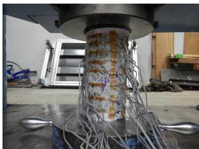
コンクリートコアの圧縮強度試験において表面からの深さごとのひずみを測定し、コンクリートの劣化深さを推定します。
