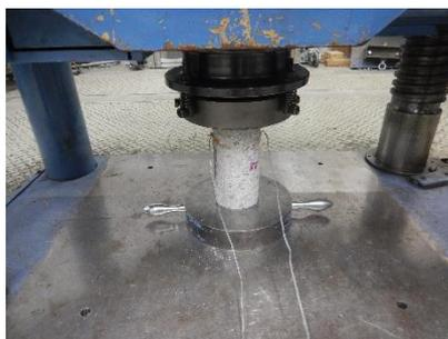
火災の影響を受けている箇所から採取したコンクリートコアにより圧縮強度、静弾性係数を求め、火災の影響を受けていない箇所や設計時の強度と比較します。
