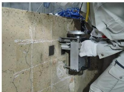
コンクリート表面に塗料を付け、一定の荷重をかけて引っかけ傷を加え、その傷幅を測定することで、コンクリート表面の被災状況を推定します。
