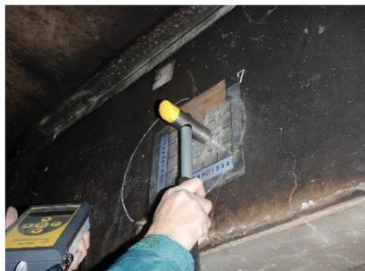
打撃装置を用いて NDIS 3434-3 に基づきコンクリート表面を打撃し、打撃力の時間波形の測定、解析を行うことで、火災の影響を確認します。
