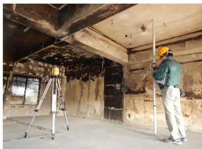
火災の影響を受けている水平部材について、レベル測定器などを用いて変形量を測定し、火災による過大なたわみの有無を確認します。
