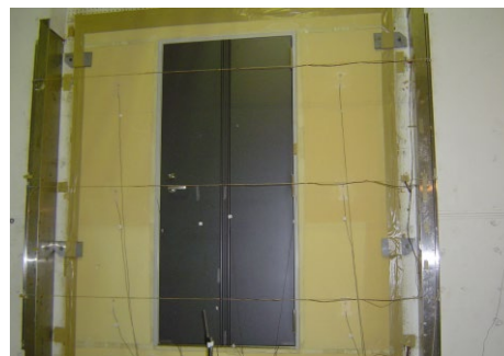
玄関ドアの熱貫流率試験の状況
