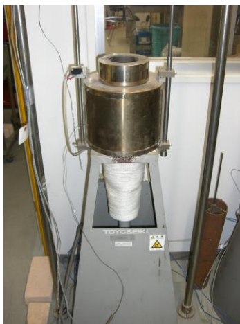
写真-1 不燃性試験装置
