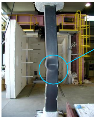
試験終了後の試験体の状況 (局部座屈が生じ不合格になった例)
