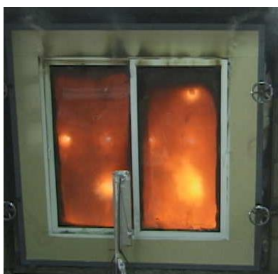
非加熱側の試験体の状況
