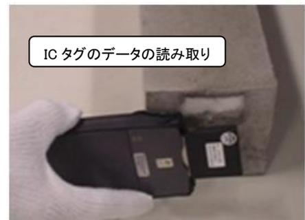
場に出向き、コンクリート供試体の製作、運搬および IC タグの挿入（または貼付け）作業を実施。
