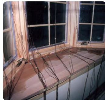
窓の結露試験(熱試験)
