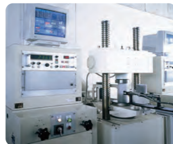
全自動コンクリート圧縮強度試験
