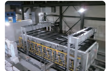
水平炉(床・はり炉)
