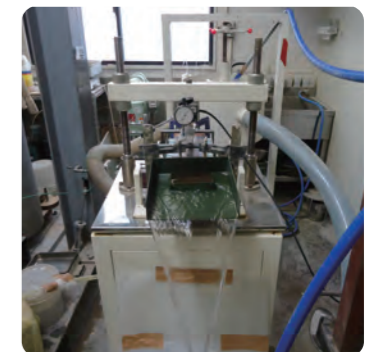
擁壁用透水マットの性能試験
