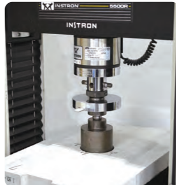
万能試験機を用いた各種試験
