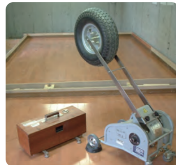
床材の床衝撃音試験(音響試験)
