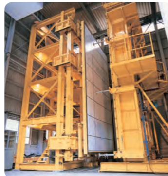
外壁パネルの変形性試験(動風圧試験)
