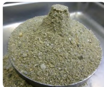
コンクリート用骨材の品質試験(密度・吸水率試験)
