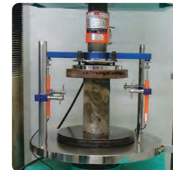
地盤改良土の一軸圧縮試験
