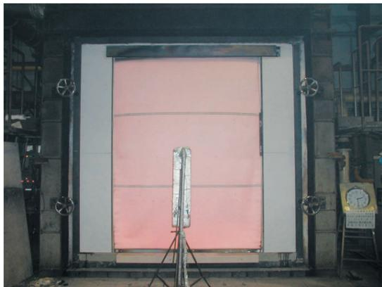
クロススクリーン特定防火設備（壁炉）
