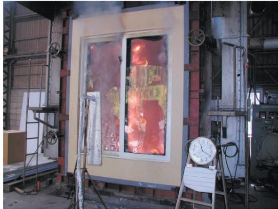
両引き窓防火設備（壁炉）
