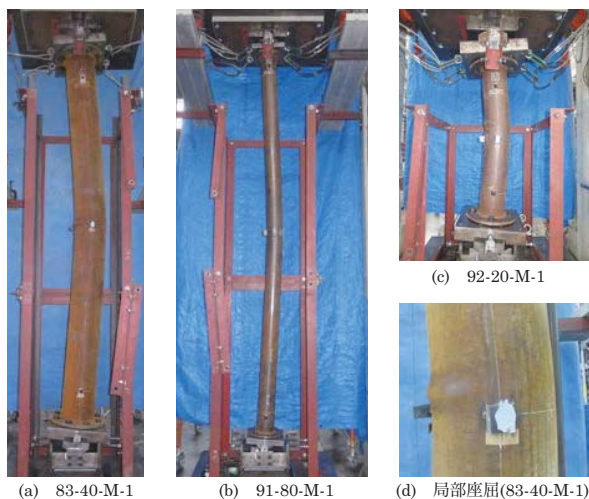
写真-1 試験後の変形状況
