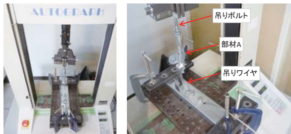
写真-5 試験体設置状況
