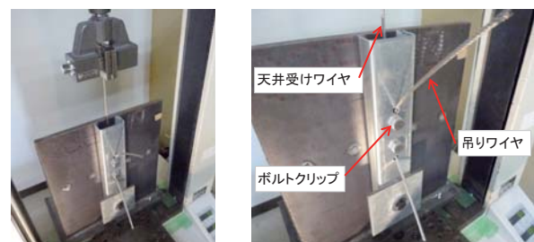
写真-7 試験体設置状況
