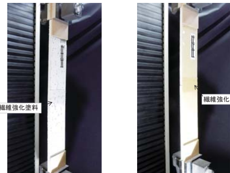
写真-9 試験体設置状況[引張試験](左: GBT、右: PBT)
