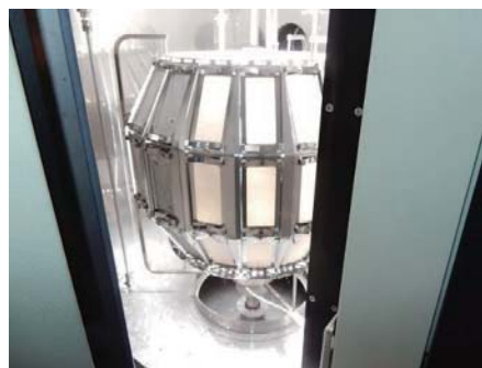
写真-3 促進耐候性試験状況
