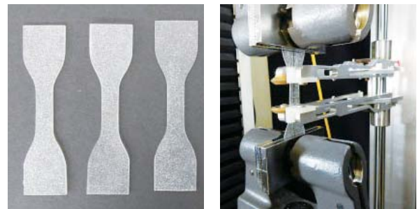
写真-4 試験片および引張試験状況
