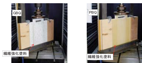
写真-11 試験体設置状況[せん断試験]
