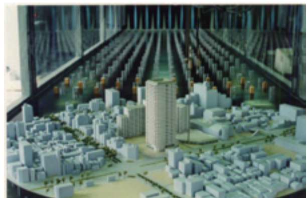
写真-1 風洞実験（風環境評価）
