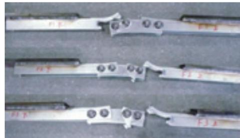
写真 3-4 試験体 F1 ~ F3 の破壊状況
