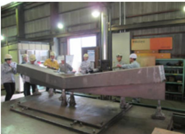
図-13 隅角部接合部 鋳鋼製品検査
