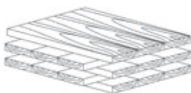
図-1 直交集成板(CLT)の構成模式図
