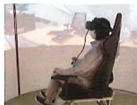
地震時の室内の揺れをVR映像と振動デバイスで再現し、体感できるシステムです。耐震構造・免震構造の揺れの違いをリアルに体感できます。(株式会社竹中工務店)
