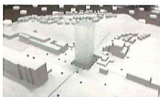
当法人では、高層建築物と周辺市街地模型を用いた風洞実験業務を行っております。業務効率化のため、現在3Dプリンターによる実験模型製作に取り組んでおります。(GBRC環境部 耐風試験室)
