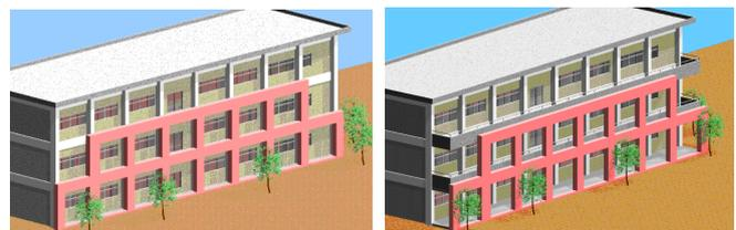
直付け工法 増設工法
