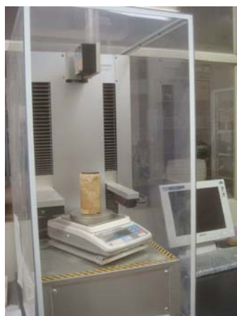
写真2 供試体の寸法・質量自動測定装置
