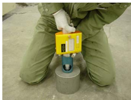
写真 3 : テストアンビルによる点検状況
