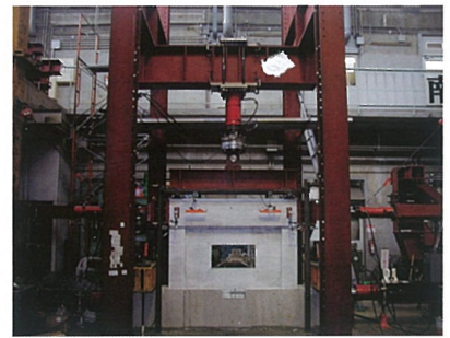
RC増設耐震壁の実験
