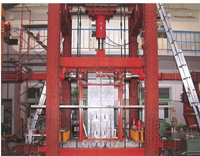
RC造PCa壁柱の実験
