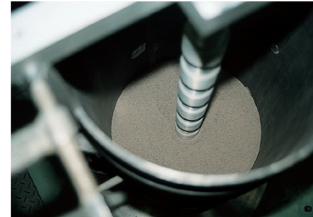
模型改良体設置状況
