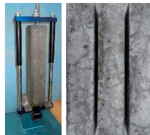
コンクリート試験体の膨張率測定
