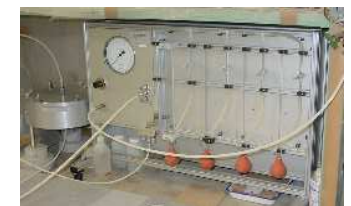
RILEM透気性試験装置
