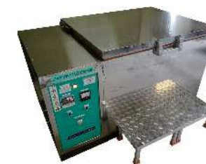
温度可変式恒温湿潤養生槽
