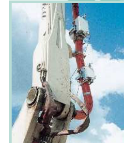
現場における生コンクリートの単位水量自動計測
