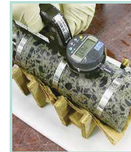
コンクリートコアの膨張量測定
