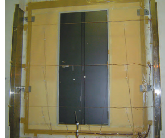
玄関ドアの熱貫流率試験状況
