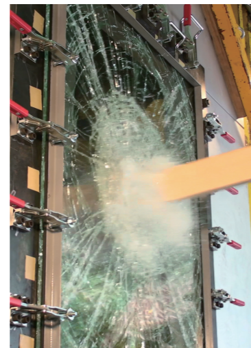
ガラスの飛来物衝突試験
