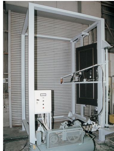
建具(ドアセット)の開閉繰返し試験
