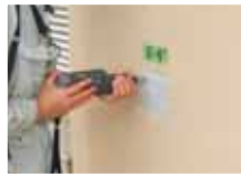
コンクリートの反発度測定
